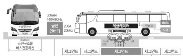
그림 1 OLEV 시스템의 원리 Fig. 1 OLEV system principle
