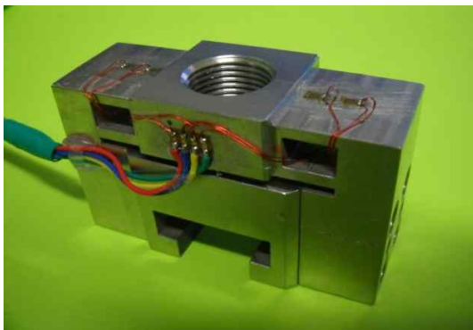
그림 4. 제작된 힘센서. Fig. 4. Manufactured force sensor.
