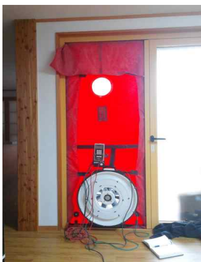
Fig. 8. Blower Door Test
