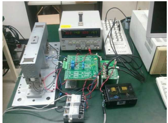
그림 6. 자기부상 시스템 실험 장치. Fig. 6. Experiment equipment of magnetic levitation system.
