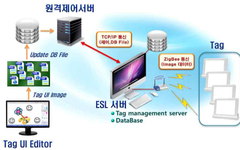
그림 1. ESL 시스템 구성도 Fig. 1 System diagram of ESL
