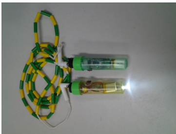
그림 16. 자가발전 줄넘기를 이용하여 LED를 발광시켜 손전등의 형태로 개발한 프로토타입.
