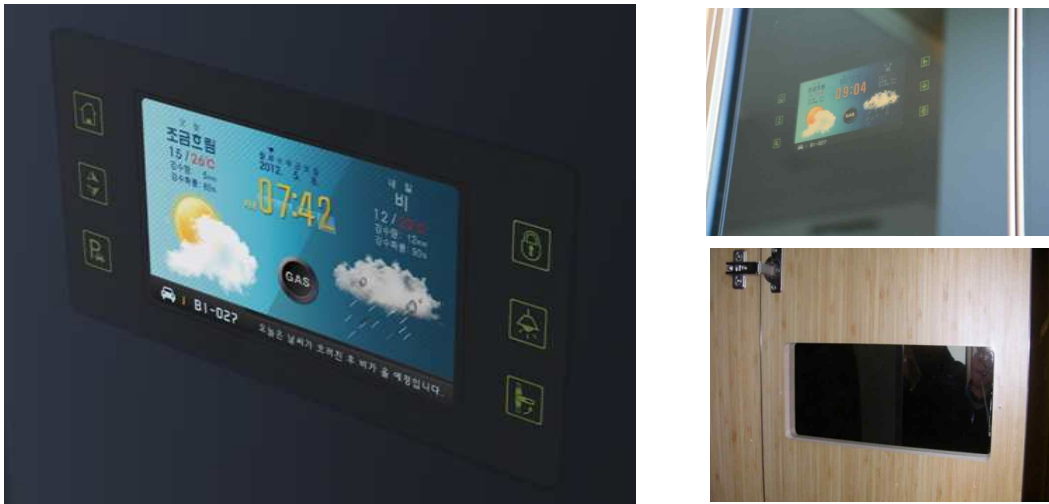
그림 6. 일괄소등스위치가 융합된 날씨 생활 정보기(신발장 설치)
