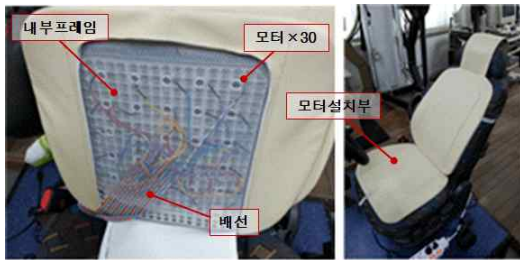
그림 3. 30개의 진동모터가 장착된 차량용 햅틱시트
