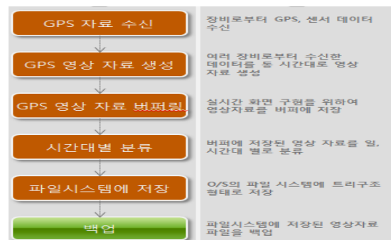
그림 2. GPS 자료의 3D 영상파일 생성 과정 Fig. 2 GPS Data to 3D Video File Creation Process
