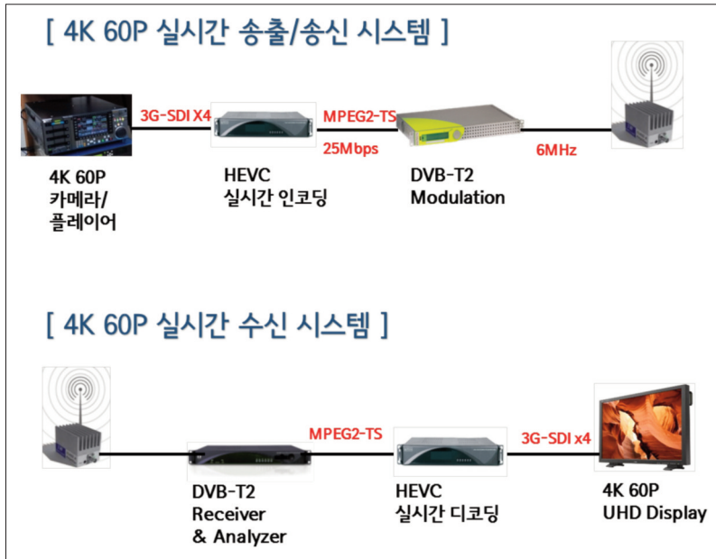
〈그림 1〉 MBC 4K 60P 실시간 실험 방송시스템 구성도
