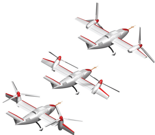
그림 1. TR-60 확장날개 무인기의 천이과정. Fig. 1. Conversion procedure of TR-60WE model.
