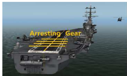
그림 12. 어레스팅 기어/훅을 이용한 착륙방법. Fig. 12. Landing Method using Arresting Gear / Hook.
