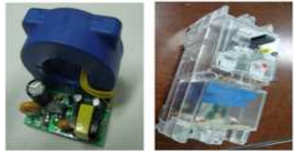
그림 9. 개발된 제품의 사진 Fig. 9. The picture of developed DC ELCB.
