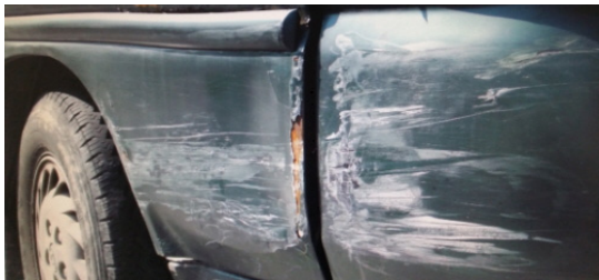
그림 6. 그레이스 전면 우측모서리 파손상태
