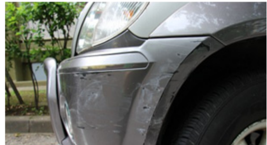
그림 5. 테라칸 좌측 앞부분 파손 상태
