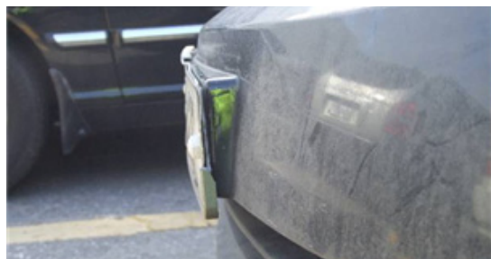
그림 1. SM5 전면 번호판 파손 상태
