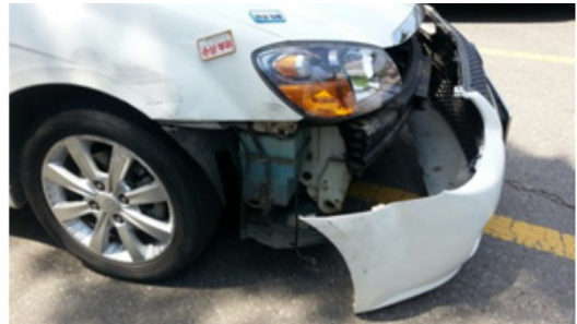
그림 4. 썰라토 우측 앞부분 파손 상태
