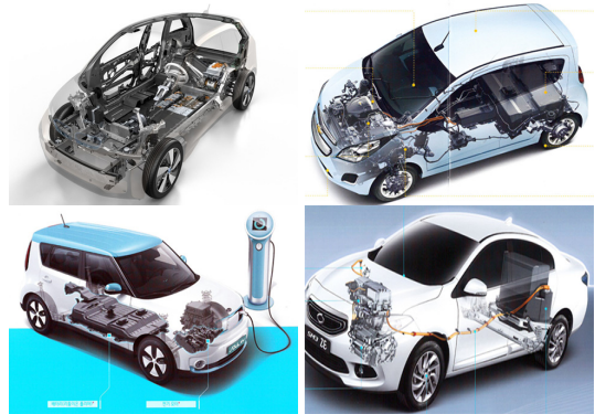
그림 3. 전기차별 전기계통 부품 구조 개요도
