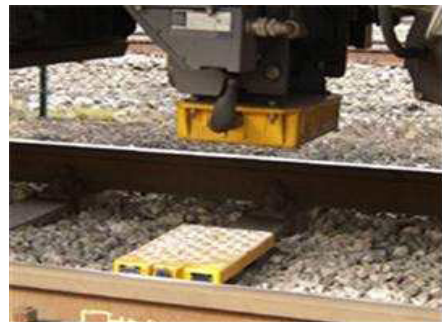
그림 4. 차상안테나 설치 예시 Fig. 4 Example of CAU installation
