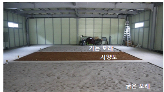
[그림 10] 지뢰 탐지 시험장에 매립한 토양 사진
