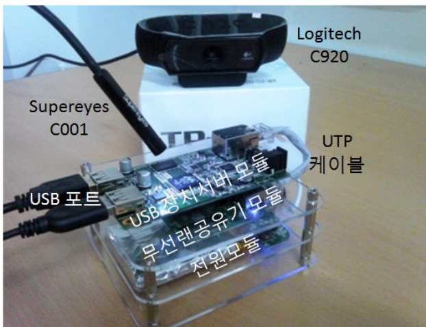
그림 5 성능 평가를 위해 상용 내시경 카메라(Supereyes C001) 및 웹캠(Logitech C920)과 연결된 무선통신 모듈
