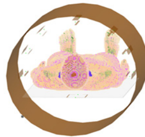
그림 2 상하부삽입형 8 채널 pTx Array 코일의 구조, 환자의 상부에 7채널의 TEM Element가 존재하고 환자의 아래쪽에 Loop Element가 배치되어 총 8 채널의 pTx Array를 구성한다.
