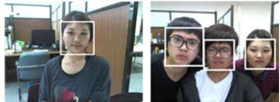
그림 4. AdaBoost 알고리즘을 이용한 얼굴 탐지 결과 Fig. 4. Results of facial region detection using AdaBoost algorithm
