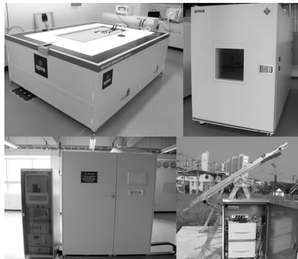
Fig. 1. Test equation (모듈시뮬레이터, 환경챔버, UV 시험장비, 옥외노출 시험장비)
