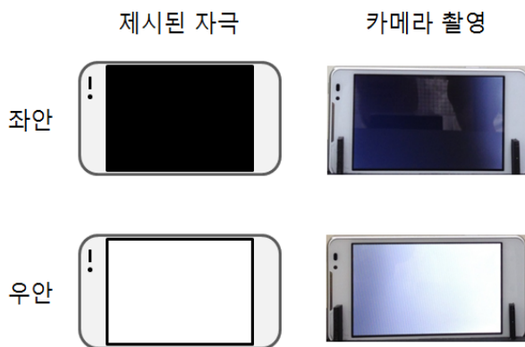
그림 4. 패럴랙스 배리어 방식의 3D 디스플레이에서 나타나는 양안 영상 분리 Fig. 4. Left/right stimuli and images in the parallax barrier type 3D display employed in the experiment
