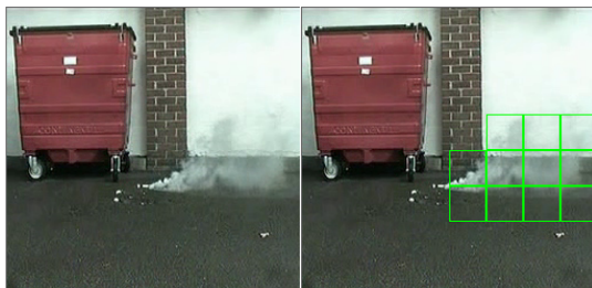
그림 1. 제안한 방법을 이용한 연기 검출 결과
