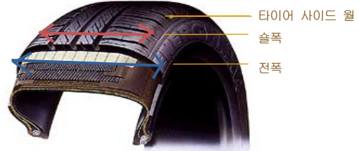
그림 1. 트레드의 전폭과 솔폭 Fig. 1 Tread width and shoulder width
