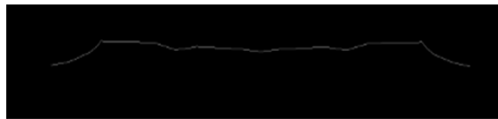
그림 12. 세션화된 결과 영상 Fig. 12 The resulting image thinning
