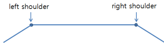
그림 13. 트레드 영상의 모델과 솔더 검출 Fig. 13 Image model of the tread and shoulder detection
