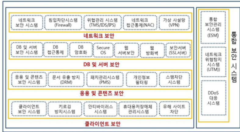
그림 1. 기존 캠퍼스 환경에 적용되었던 통합 보안체계 Fig. 1 Integrated security system applied to the existing campus environments
