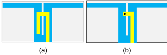
그림 2. 평면 다이폴 급전 구조들: (a) 마이크로스트립 개방 스텐트로 종단 (b) 단락 종단 Fig. 2 Feeding geometries for planar dipole: (a) terminated by MS open stub (b) terminated by short circuit
