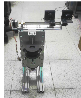
그림 8. 스테레오-2차원 레이저 거리측정 융합 시스템
