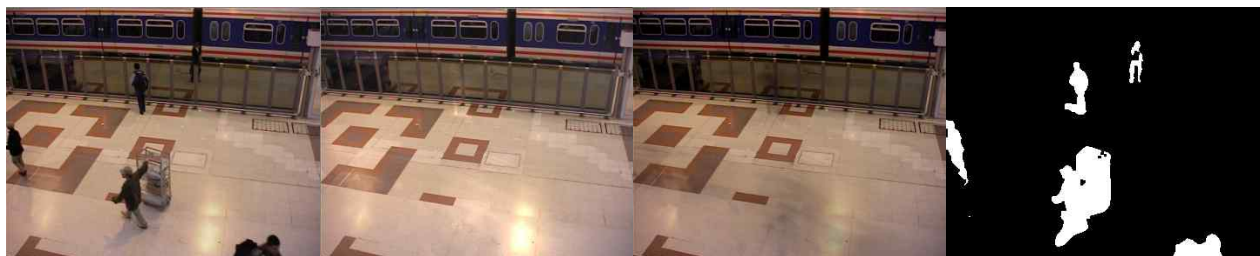
(a) 입력 영상 (b) 상위 임계영상 (c) 하위 임계영상 (d) 객체검출 결과
