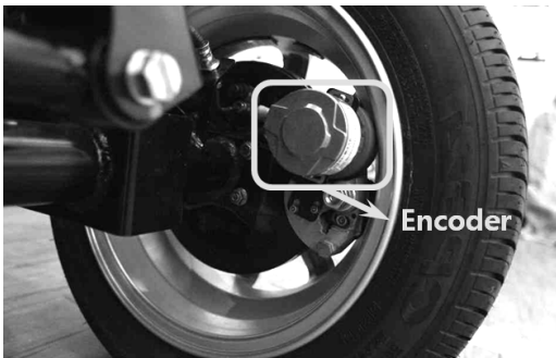
<그림 2> 후륜 휠에 장착된 엔코더 <Fig. 2> Encoder mounted on the rear wheel
