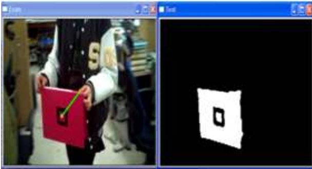
그림 9. 표적 감지를 위한 영상 처리 (좌-원본 영상, 우-출력 영상)
