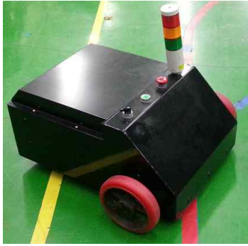
그림 1. 자기테이프를 이용하는 연구용 AGC Fig. 1. AGC for research using magnet-tape
