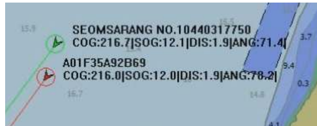
그림 1. 동일선박에 대한 AIS, Radar 두 장치의 오차 Fig. 1. Device error between AIS and Radar data about same ship
