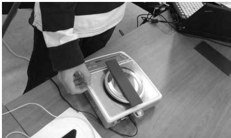
[그림 I-3] 질량비를 이용한 무게중심 확인실험 중 질량계기
