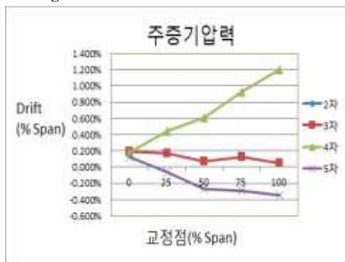
Fig. 3-7. 증기발생기 압력 계측기 drift
