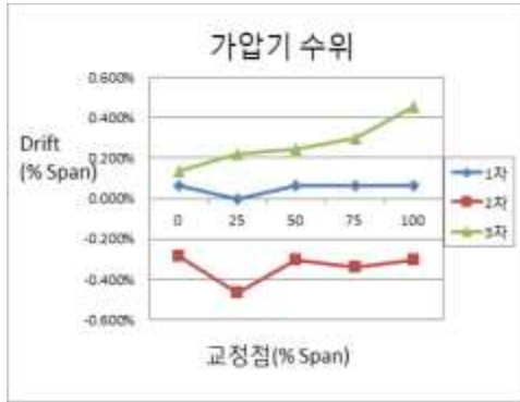
Fig. 3-3. 가압기 수위 계측기 drift
