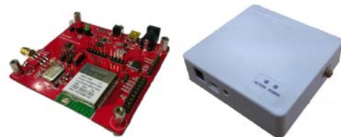
그림 4. 위치 추적용 프로토타입 장치 하드웨어 Fig. 4 Location tracking device prototype hardware
