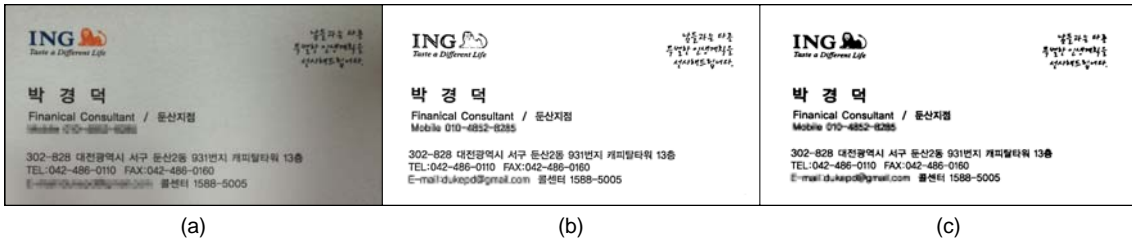
그림 11. 명함 영상의 이진화 기법 (a) 원본 영상 (b) Sauvola 이진화 (c) 적응형 이진화 Fig. 11 Binarization for Business Card Images (a) Original Image (b) Sauvola Thresholding (c) Adaptive Thresholding
