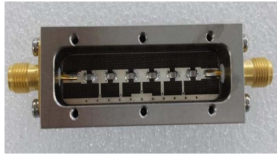
그림 7. 마이크로스트립 고역통과필터의 사진 Fig. 7 Photograph of microstrip high pass filter
