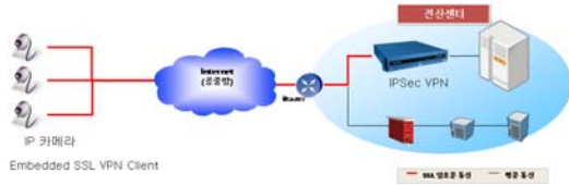
그림 4. SSL VPN을 이용한 보안 네트워크 (IP 카메라를 예로 든 것일 뿐 모든 임베디드 시스템에서 동일하다)
