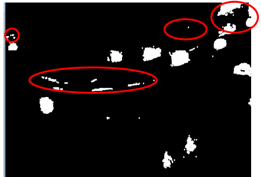
그림 2. 자동차 객체 추출 영상과 잡음 Fig. 2. Image about getting car object and noise
