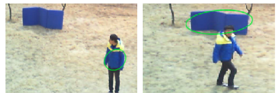
그림 8. 유사색상의 물체로 인해 불완전한 추적 성능을 보이는 개선된 CamShift 알고리즘 Fig. 8. Improved CamShift algorithm showing an incomplete tracking performance due to the object of similar color
