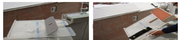
그림 12 기존 마이크로스트립 4×16 배열 안테나 및 제안한 4×16 혼 도파관 배열 안테나 측정
