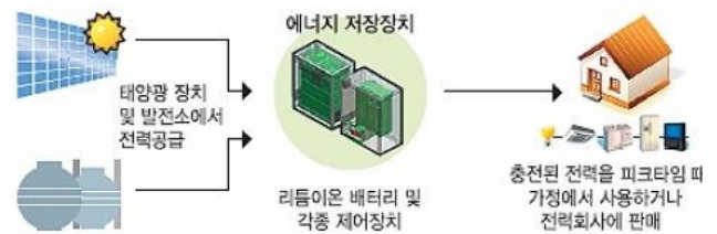
그림 1 마이크로 그리드의 에너지 저장 장치 운용 Fig. 1 ESS Operation of Micro Grid
