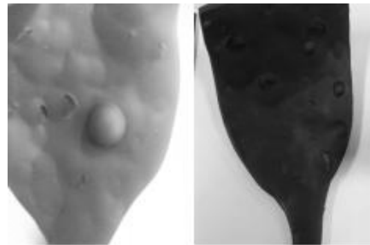
Fig. 7. Blistering after immersion test : FKM : 30℃, 50bar, 24hr.
