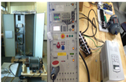
[그림 2] PDS와 엘리베이터 설비에 대한 저주파수 EMC 검증 시험 사진
