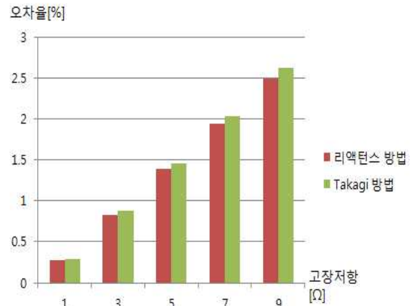
그림 7. 고장저항의 변화를 준 오차(X=0.5인 경우) Fig. 7. error to the changf fault resistance (case X=0.5)
