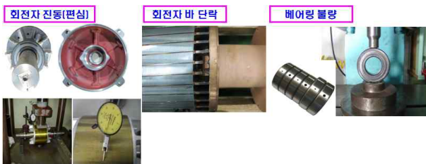
그림 7. 유도전동기의 고장모의 Fig. 7. Faulted condition of induction motor
