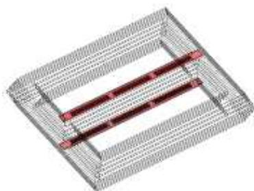
그림 3. Tie-plate를 추가한 3D FEM 모델 Fig. 3. 3D FEM model for tie-plate
