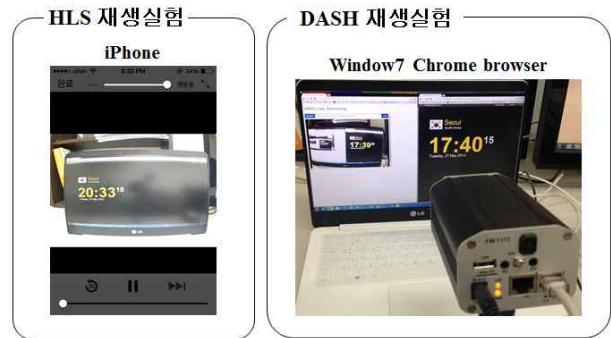
그림 5. IP 카메라를 이용한 라이브 스트리밍 실험 화면 Fig. 5. Live Streaming Monitoring With IP Camera
