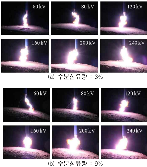
그림 2. 수분함유량이 3과 9%인 가는 모래의 정극성 1.2/50 \mu s 뇌임펄스에 대한 방전광 사진 Fig. 2. Photographs of discharge light for fine sand with 3 and 9% moisture contents under the 1.2/50 \mu s lightning impulse voltage for the positive polarity
