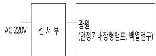
그림 5. 일반 센서등기구의 배선도 Fig. 5. Wiring diagram of general sensor luminaires
