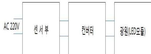
그림 4. LED센서등기구의 배선도 Fig. 4. Wiring diagram of LED sensor luminaires
